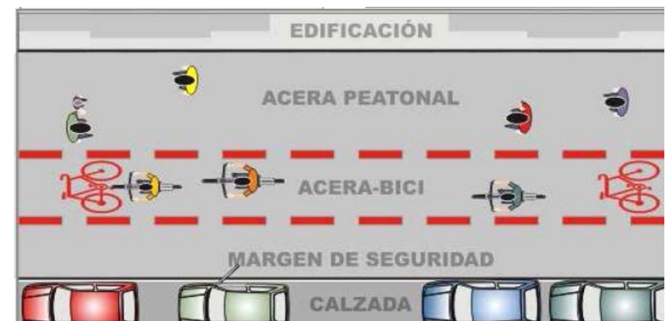
Margen de seguridad en acera bici
